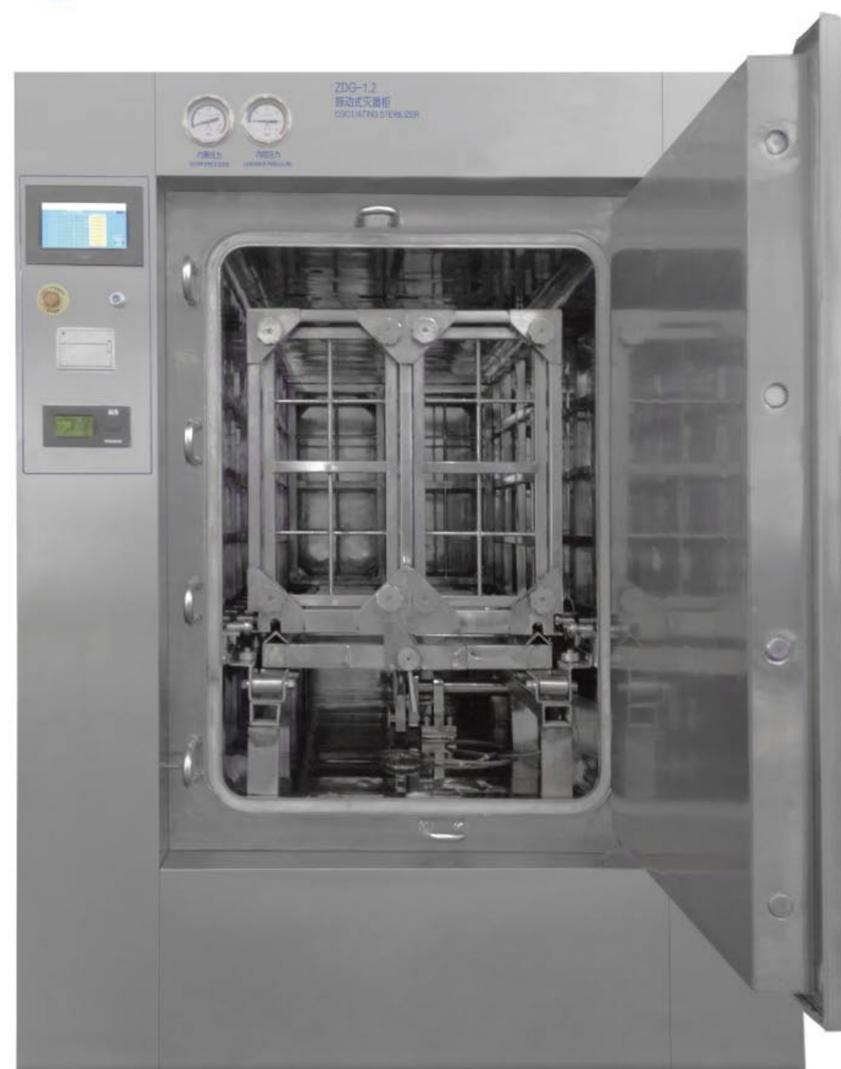
本系列设备主要适用于混悬剂和乳剂的灭菌，设计制造完全符合GMP要求。在整个灭菌过程中，设备处于密闭状态并且运行稳定，温度均匀。设备装载系统以固定速度前后移动。我们精密的设计和精湛的加工技术，将使您价格不菲的产品获得最佳的灭菌效果。
