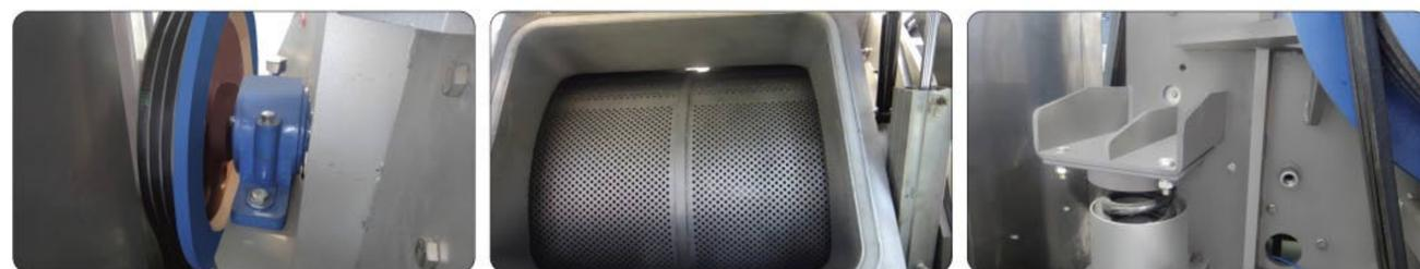
我公司生产的MXJ系列灭菌洗衣机是新一代适用于医疗及制药生产过程的无菌环境中的洁净工作服的洗涤、灭菌、干燥的多功能设备。灭菌洗衣机严格按照GB 12021.4-2004《电动洗衣机能效限定值及能源效率等级》、GB 17202-1997《工业电动洗衣机安全要求》、GB/T 4288-2008《家用和类似用途电动洗衣机》、GB150-2011《压力容器》和TSG R0004-2009《固定式压力容器安全技术监察规程》设计、制造、验收。灭菌洗衣机可以在同一设备内完成进衣物、浸洗、粗洗、精洗、脱水预干、灭菌、干燥、冷却、出衣物等操作过程，达到缩短洗衣流程和洗衣周期时间及减少污染的目的。
