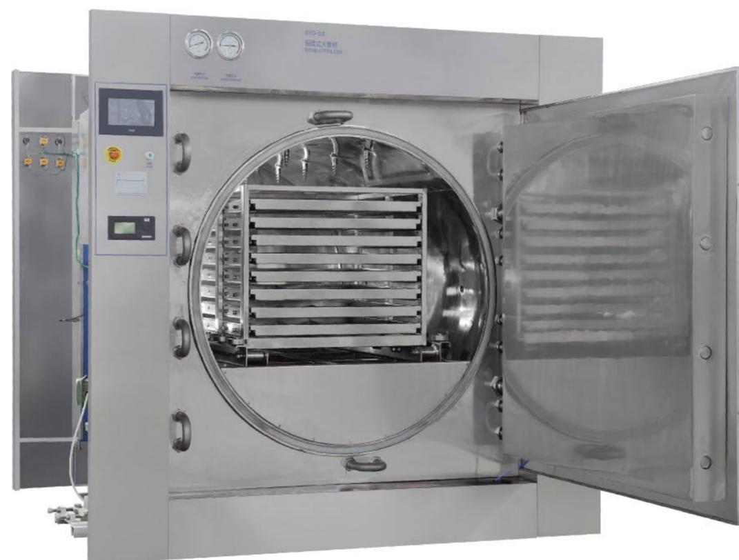
本系列设备主要适用于混悬剂和乳剂的灭菌。在整个灭菌过程中，设备处于密闭状态并且运行稳定，温度均匀，完全符合GMP要求。设备装载系统通过驱动装置带动摇摆。我们精密的设计和精湛的加工技术，将使您价格不菲的产品获得最佳的灭菌效果。
