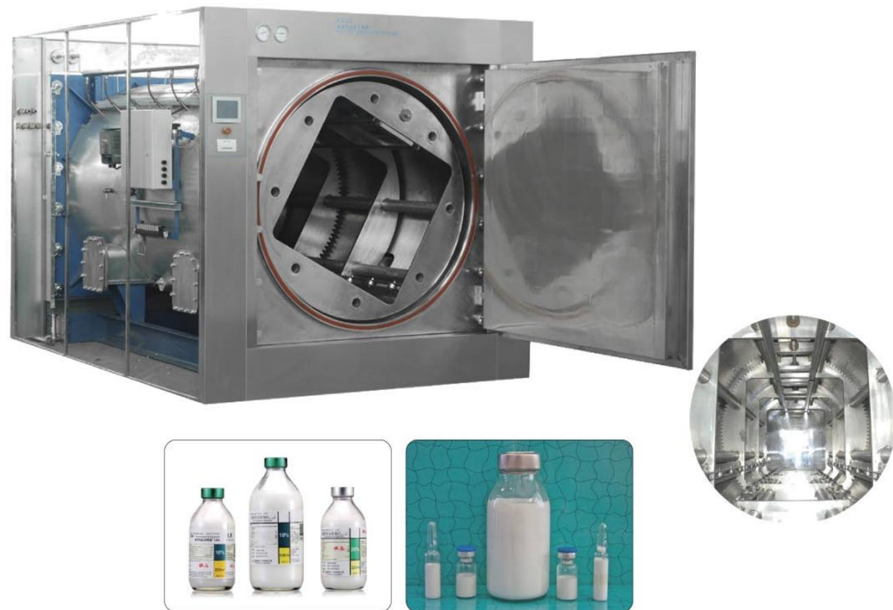
该设备采用过热水进行喷淋，主要设计用于灭菌装在密闭容器中的液体，例如氨基酸和脂肪乳。在整个灭菌过程中为了保证灭菌的温度均匀及避免药液凝结或分层，我们提供了一种可旋转装载系统结构，装载灭菌物品的灭菌车以一个可调整的速度不断地旋转。
