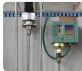
高精度压力控制元件
